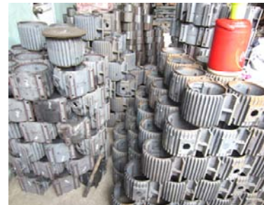
写真3 部品例 (ポンプ・モータ・ケーシング)
